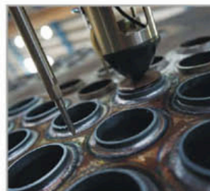
ماشین جوش اوربیتال تمام اتوماتیک از برند Polysoude فرانسه Fully automatic orbital welding machine of French polysoude brand
