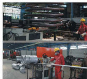
ماشین نورد لوله هیدرولیک CNC با قابلیت کار از قطر 3/4 inch تا 6 inch CNC hydraulic pipe rolling machine, capable of working from 3/4 inch to 6 inch
