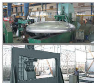
ماشین لبه زن الیپتیکال با قطر کارگیر حداکثر 45 mm و ضخامت حداکثر 4000 mm Elliptical Flanging machine with a working diameter of 4000 mm and a working thickness of 45 mm
