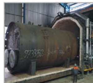
کوره عملیات حرارتی و تنش زدایی °C 1100 با حجم 500 مترمکعب و دقت دمایی °C ± 5 Post-weld heat treatment furnace 1100 °C with a volume of 500 m 3 and temperature accuracy of +/- 5 °C
