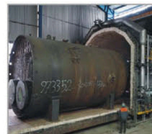
کوره عملیات حرارتی و تنش زدایی 1100 °C حجم 500 مترمکعب و دقت دمایی 5°C ± Post-weld heat treatment furnace 1100 °C with a volume of 500 m³ and temperature accuracy of +/-5 °C
