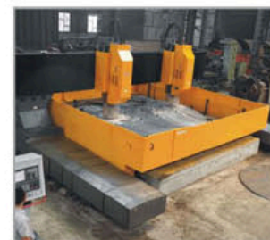
دستگاه دریل فرز CNC با تکنولوژی زیمنس آلمان و کارکرد همزمان دو اسپیندل با ابعاد کارگیر 5000 mm × 5000 mm CNC milling drill, Siemens technology and two spindles working at the same time, working width 5000mm × 5000 mm
