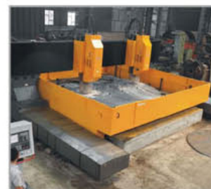
دستگاه دریل فرز CNC با تکنولوژی زیمنس آلمان و کارکرد همزمان دو اسپیندل 5000 mm × 5000 mm با ابعاد کارگیر CNC milling drill, Siemens technology and two spindles working at the same time, working width 5000mm × 5000 mm
