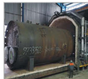
کوره عملیات حرارتی و تنش زدایی 1100 °C حجم 500 مترمکعب و دقت دمایی 5°C ± Post-weld heat treatment furnace 1100 °C with a volume of 500 m 3 and temperature accuracy of +/-5 °C
