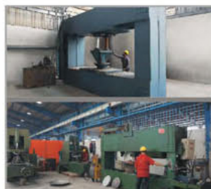
ماشین پرس هیدرولیک دروازه ای 600 Ton به عرض 4000 mm 600 Ton Hydraulic pressing machine, 400MM width
