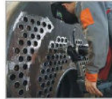
ماشین والس از برند Technodata آلمان Expanding machine of German techno data brand
