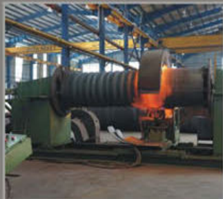
ماشین کاروگیت با طول کارگیر حداکثر 6000 mm و ضخامت کاری تا 25 mm corrugating machine, 6000 mm length and 25 mm working thickness
