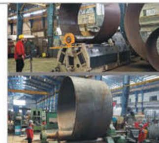
ماشین نورد 4 غلتک هیدرولیک CNC با ابعاد کارگیر 3300 mm و ضخامت کار حداکثر 60 mm Rolling machine with 4 hydraulic rollers, 3300 mm working width and 60 mm working thickness
