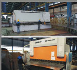
گیوتین برش CNC عرض 6 متر و پرس برک 300 Ton - CNC CNC guillotine cutting machine, width 6 meters and CNC brake press-300Ton
